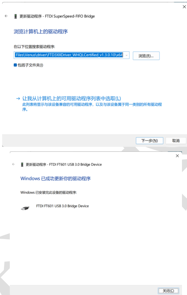
图 8 手动安装 USB3.0 驱动
